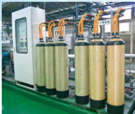
18 mega \Omega 超純水供應系統
